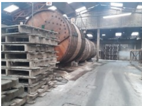
Foto 23. Fulones para el manejo de pieles vacunas utilizados en la planta para los procesos de remojo, piquelado, desengrase, curtido y recurtido.
