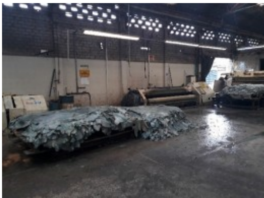
Foto 23. Fulones para el manejo de pieles vacunas utilizados en la planta para los procesos de remojo, piquelado, desengrase, curtido y recurtido.
